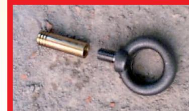
Fixation des anneaux sur le Béton (cheville métallique)
